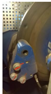
Pinza de freno sin insertar la T de bloqueo en uno de los agujeros del disco de freno. Brake caliper without inserting the locking T into one of the brake disc holes.
