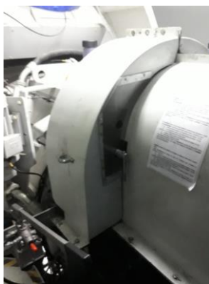
Tren de potencia con la T de bloqueo ya insertada. Drive shaft with T lock inserted.
